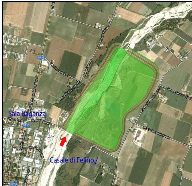
▪ Figura 3-17 - Ubicazione e forma della cassa di espansione PP 2015 [fonte: PP 2015].
